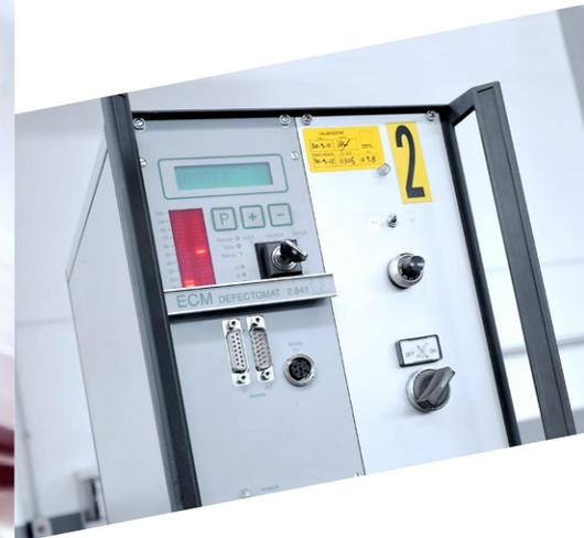
Il processo di produzione del tubo consente di controllare direttamente in linea ed al 100% sia la corretta esecuzione dell'operazione di saldatura, sia la lamiera stessa sull'intera sezione. Questa verifica avviene con una apparecchiatura di controllo a correnti indotte denominata più comunemente "Eddy Current".
